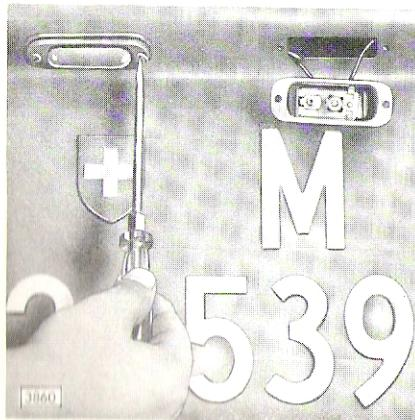
Abb. 146 Birnen der Kontrollschildbeleuchtung wechseln
