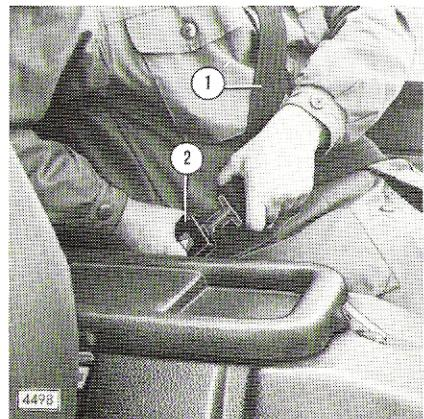
**Abb. 60 Verbindung der Sicherheitsgurte**
