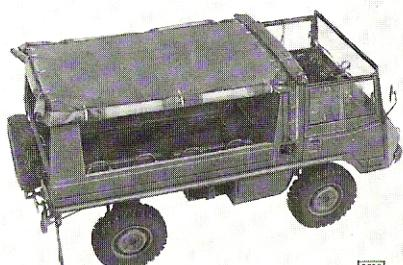
**Abb. 66 Kurzes Verdeck und Plane hinter dem Lastschutzwand aufgerollt. Großes Verdeck, Verdeckbögen und Verdeckstreben abgenommen.**
